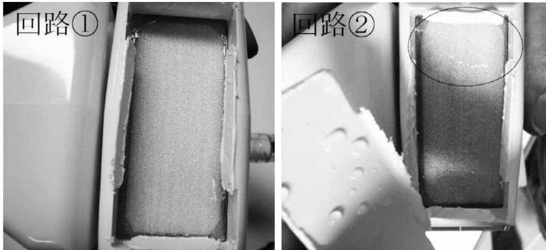
図6 ガス出口部の結露
